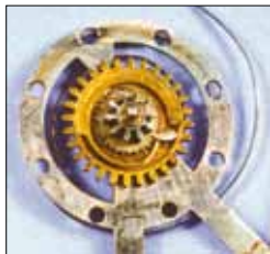
▲ Fig. 10 et 11 : Centre du rotor en haut et de la masse à oscillations limitées en bas, avec vue des inverseurs et du cercle de blocage
